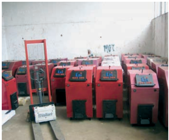
Gas Inženjering proizvodi i sopstvene kotlove na čvrsto gorivo
