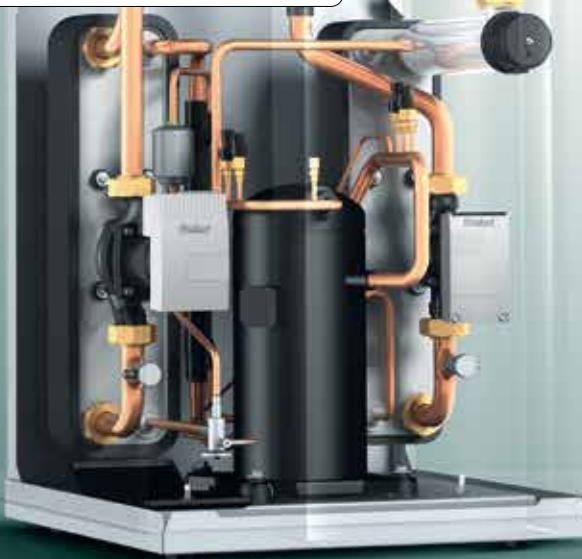
Način rada Vaillantovih toplotnih pumpi sličan je tehnologiji rada frižidera, samo obrnutim principom. U kružnom procesu (Carnot proces) toplota preuzeta od okoline (zemlja, vazduh, podzemna voda) predaje se radnom medijumu (gas R 407 C) koji se komprimuje i dovodi na višu temperaturu. Na taj način se neprimetna toplota zemlje ili vazduha pretvara u korisnu energiju u svrhu grejanja.
