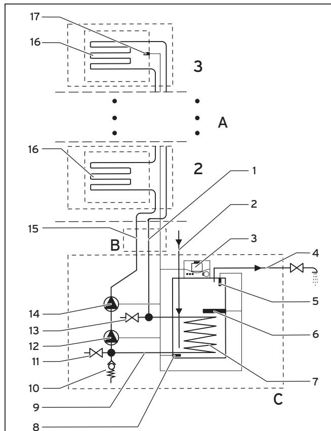
Sl. 2.3 Glavne komponente sustava auroSTEP plus sa spremnikom VEH SN 350/3 iP (načelni crtež bez pribora za priključivanje)
