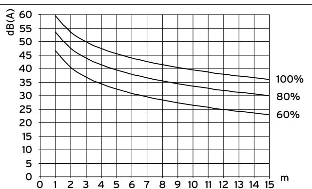
Sl. 6.3 Razina zvučnog tlaka vanjske jedinice u dB(A), ovisno o udaljenosti i broju okretaja ventilatora za VWL 102/3 s u slučaju postavljanja na otvoreno
