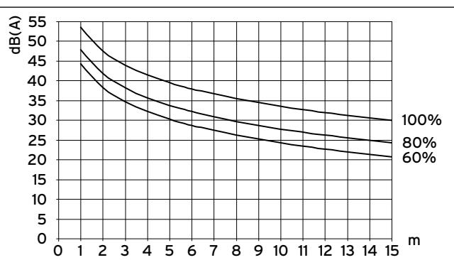
Sl. 6.2 Razina zvučnog tlaka vanjske jedinice u dB(A), ovisno o udaljenosti i broju okretaja ventilatora za VWL 82/3 s u slučaju postavljanja na otvoreno
